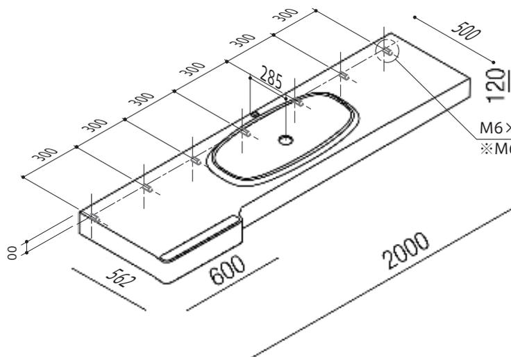
M6×L20mm取付ボルト位置 (7ヶ所) / 建築工事
